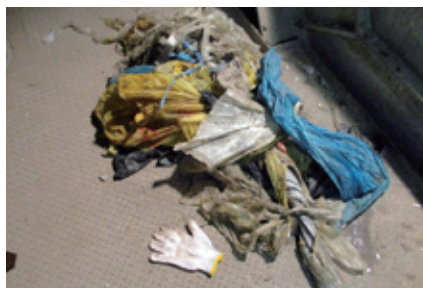
ごみ供給機に絡まった電線などの不適切なごみ。不適切なごみが混入すると機械の故障や破損の原因となります。ごみとして出す場合は、30cm以下の大きさにしてください。
