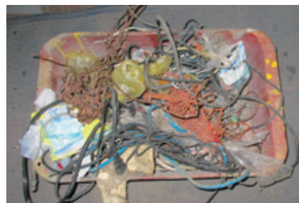
ごみ供給機に絡まった電線などの不適切なごみ。不適切なごみが混入すると機械の故障や破損の原因となります。ごみとして出す場合は、30cm以下の大きさにしてください。
