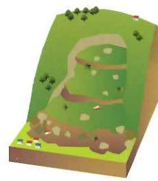
地下水の影響により、水を通してにくい地層の上の地面が、斜面の傾きにより下方向にゆっくりと滑り落ちる現象です。
