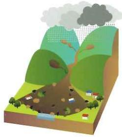
山腹や川底の石、土砂などが、長雨や大雨により、水と一緒にになって激しく流下する現象です。土石流は時速20～40kmとスピードが速く、周辺の木々や大きな岩を巻き込んで進むため、一瞬にして家や田畠を押し流してしまいます。
