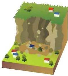
大雨や集中豪雨、地震などの影響で地盤が緩み、斜面が突然崩れ落ちる災害で、崩れた土砂が斜面の2～3倍も離れた場所に届くこともあります。人家の近くで発生すると、逃げ遅れることも多く、死者の割合が高いことも、急傾斜地の崩壊(がけ崩れ)の特徴です。
