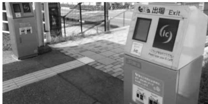
南御殿場(無人)駅に設置されたICカード読み取り機
