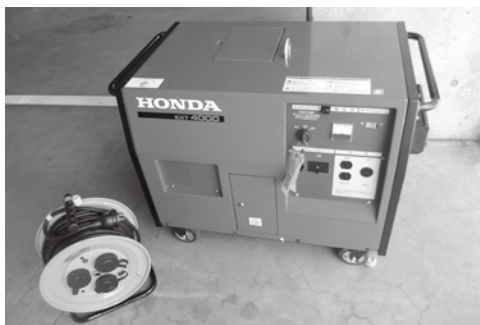
整備された発電機とコードリール
